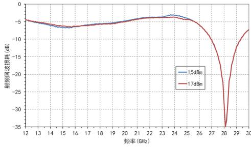
中频回波损耗VS频率 (@L0=15, 17dBm L0=14GHz)
