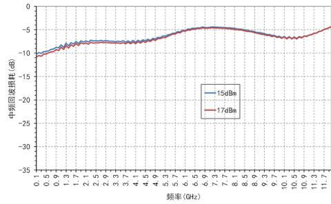
本振回波损耗VS频率 (@L0=17dBm)
