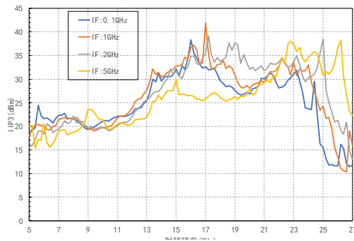
输入IIP3 VS 射频频率 低本振
